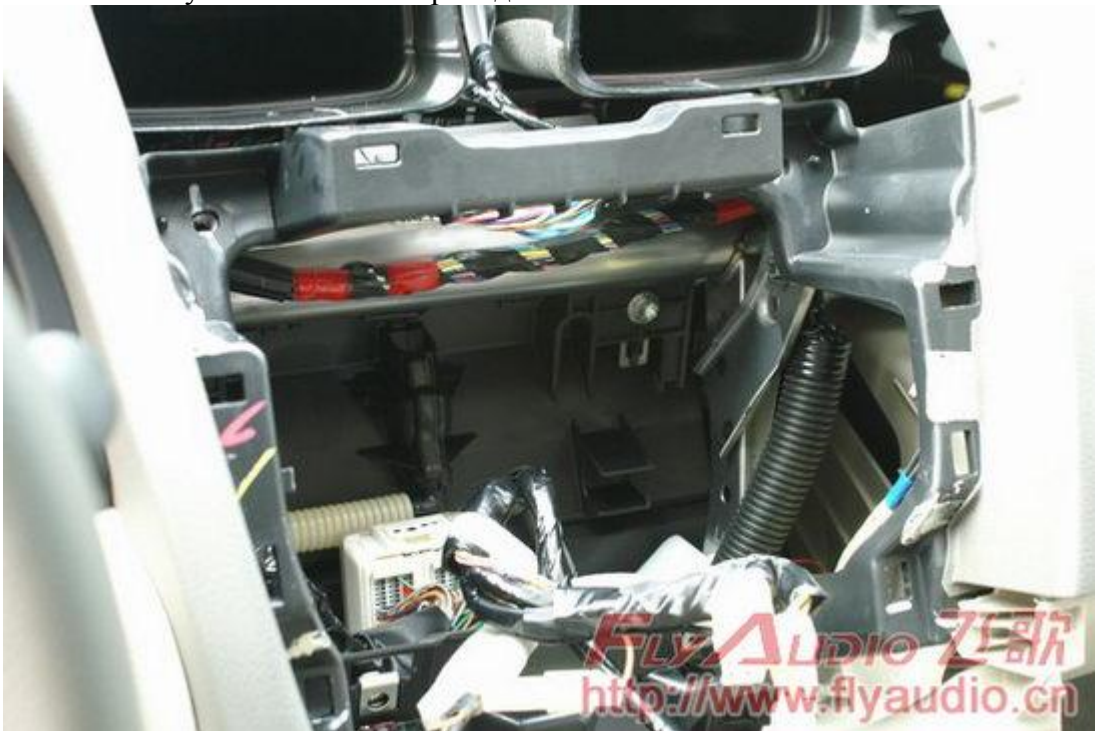
Снимите родную магнитолу и положите на полотенце, чтобы не побить. Установите родной крепеж, но новый центральный блок.
